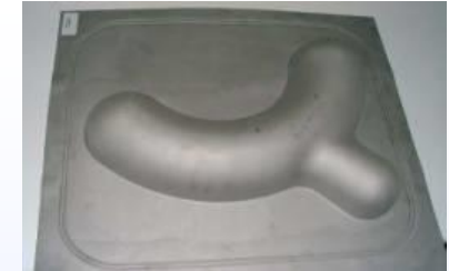
Bleed Air Duct Ti SP 700
