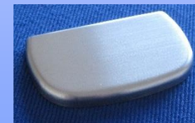
Medical Implant Ti 6-4 ELI t = 0,2-0,4 mm
