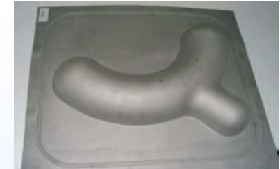
Bleed Air Duct Ti SP 700
